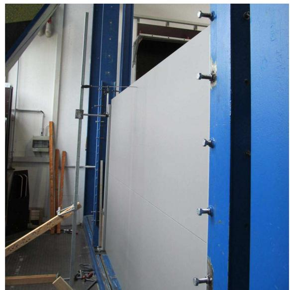
**Bild 8** Durchbiegungsmessung, Var. 2 mit Pfostenabstützhöhe ca. 480 mm
