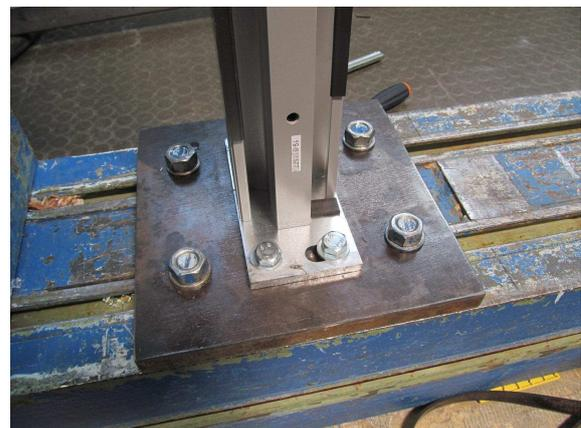
**Bild 4** Pfosten ohne Pressleiste, unten
