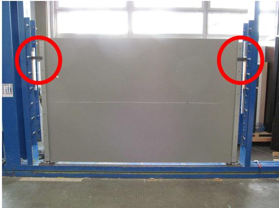
**Bild 9** Ansicht des Probekörpers (Variante 1) mit seitlicher Abstützung ca. 1720 mm
