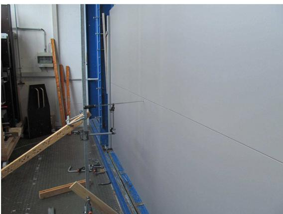
**Bild 7** Durchbiegungsmessung, Var. 1 mit Pfostenabstützhöhe ca. 1720 mm
