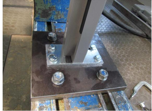
**Bild 6** Befestigung des Postens zur Basisplatte (aufgesteckt)
