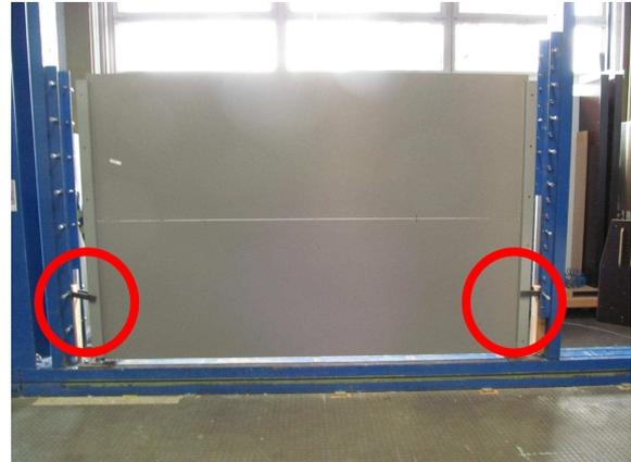
**Bild 10** Ansicht des Probekörpers (Variante 2) mit seitlicher Abstützung ca. 480 mm
