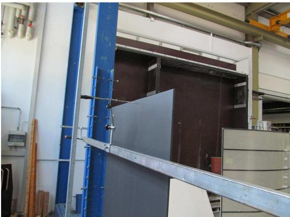
**Bild 5** Messposition der Durchbiegung während der Belastung
